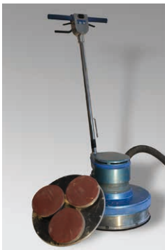
Ponceuse à trois disques abrasifs type Trio U-400 PLANET poids 70 kg, aspiration de poussière intégrée, 4 éléments; 3 disques abrasifs 17,8 cm Ø ou ses treillis abrasifs 40 cm Ø; rotation par entraînement planétaire
