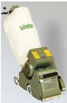
Ponceuse à bande HUMMEL poids 80 kg, trois éléments, bande de ponçage 20 cm
